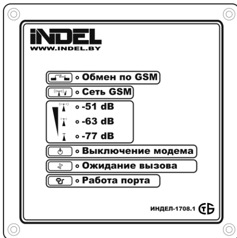
Рис 2. Внешний вид передней панели верхней секции корпуса контроллера.
